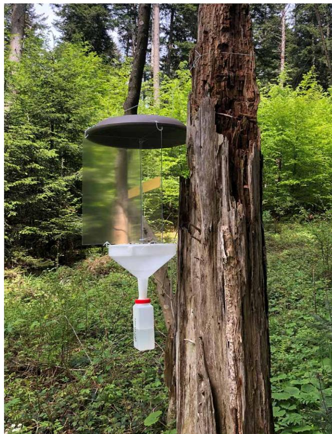
Die Flugfensterfallen werden an geeignetem Tannentotholz angebracht. Die Insekten werden durch eine gelbe Markierung angelockt, fliegen gegen die Plexiglasscheiben und fallen durch den Trichter in den darunter hängenden Behälter mit Fangflüssigkeit. (Foto: Henning Weth)
